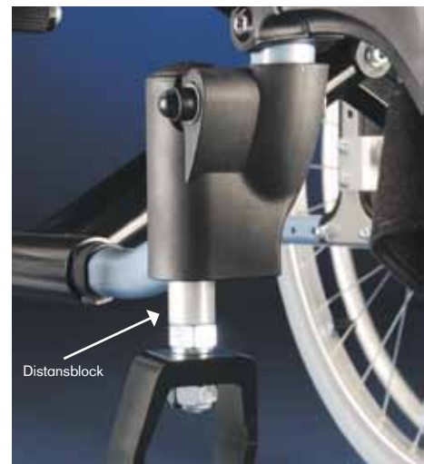
Vinkelställbar länkhjulsinfästning med distansblock.
