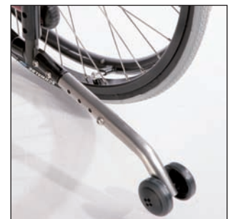
Undansvängbart tipskydd med möjlig längdjustering
